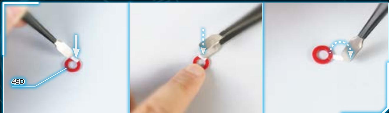
2 - Используя пинцет, поместите скотч клейкой стороной на шайбу (49D). Слегка прижмите его, а затем осторожно снимите белый защитный слой, при этом сама полоска скотча должна остаться на шайбе.
