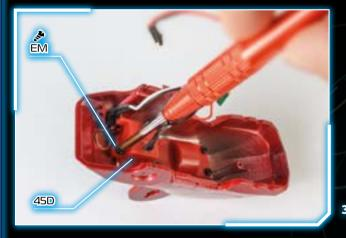
**3 -** Установите сам батарейный отсек (45D) и закрепите его одним винтом EM.
