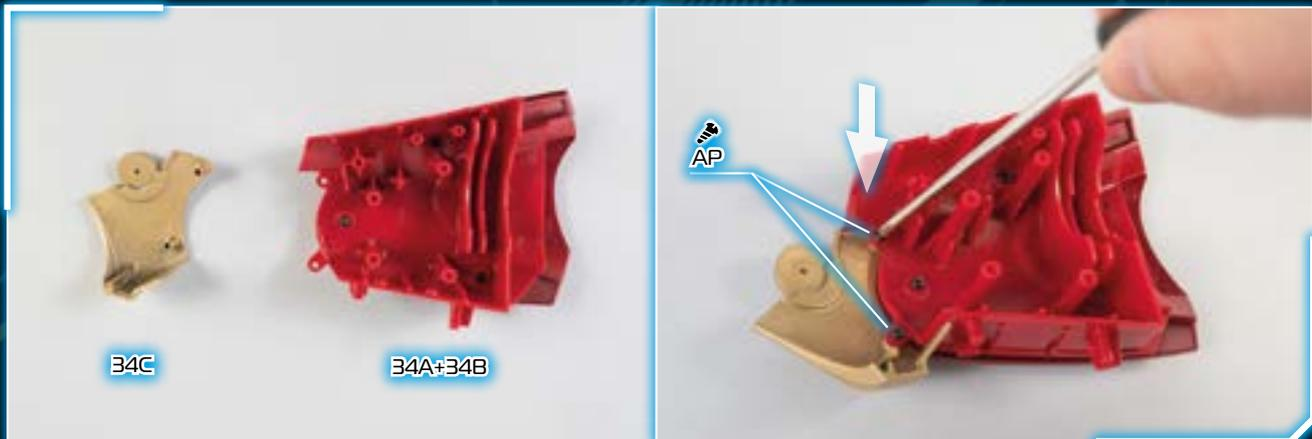
3 - Возьмите наколенную накладку 34С. Соедините ее с конструкцией, собранной из деталей (34А) и (34В), а затем закрепите двумя винтами AP.
