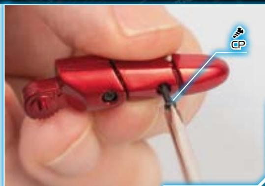
2 - Завершите сборку пальца, установив на свое место деталь 26F и закрепив ее винтом CP (его тоже не следует сильно затягивать). Проверьте подвижность фаланг пальца.
