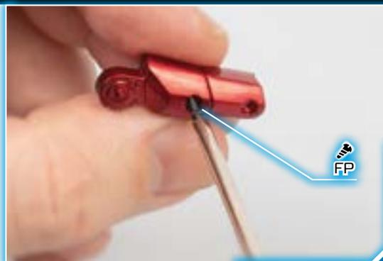
1 - Безымянный палец состоит из деталей 26D, 26E и 26F. Аккуратно соедините детали 26D и 26E так, как показано на фотографии, и скрепите их винтом FP. Не затягивайте винт слишком сильно, чтобы потом детали могли двигаться.
