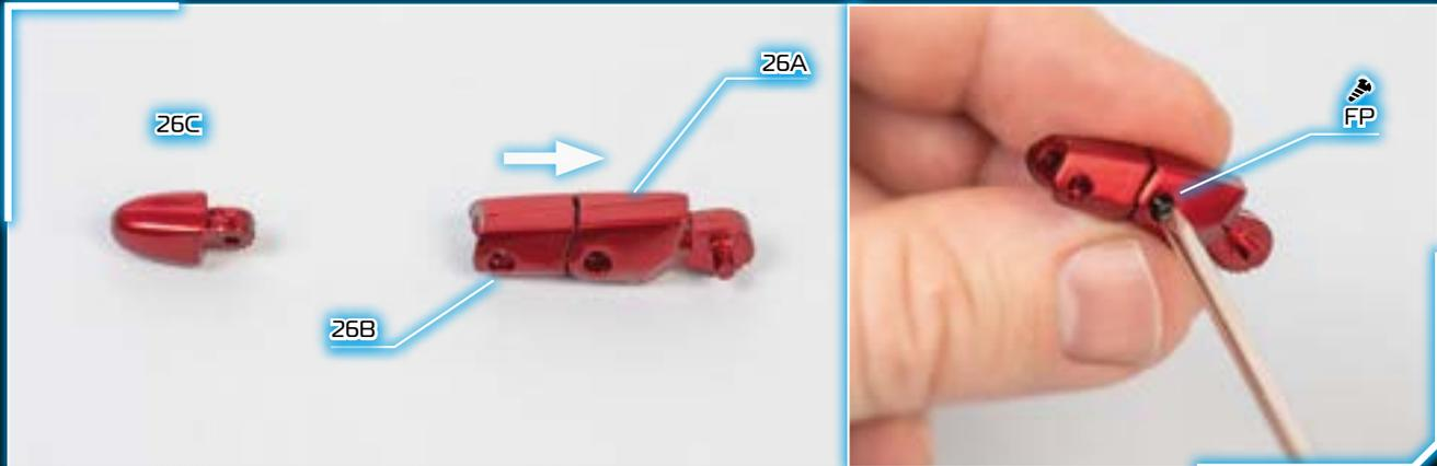
1 - Средний палец собирается из трех частей: 26А, 26В и 26С. Детали промаркированы буквой и цифрой рядом с местом крепления; для среднего пальца используется маркировка 3L. Аккуратно соедините детали 26В и 26А, после чего скрепите их винтом FP. Обратите внимание: верхняя сторона этих деталей более плоская.
