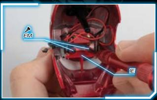
3 - Прикрутите опорную деталь к светодиодам (1E) с внутренней стороны с помощью двух винтов EM. Светодиоды должны быть направлены на основание видоискателя.
