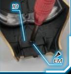
4 - На внутренней стороне маски (1A) зафиксируйте видоискатель (1B) с помощью одного винта EM. Маску В (1O) зафиксируйте с помощью одного винта EM. Язычок маски должен входить в паз шлема: закрепите его при помощи магнитной отвертки.
