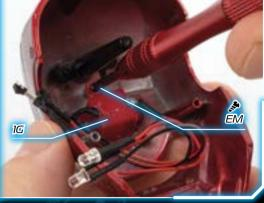
2 - Светодиодное устройство (1G) включает в себя отсек для батарейки, два светодиода для видоискателя и переключатель питания. Расположите светодиод (1G) так, чтобы отверстие находилось с внешней стороны корпуса шлема, и зафиксируйте его при помощи одного винта EM.
