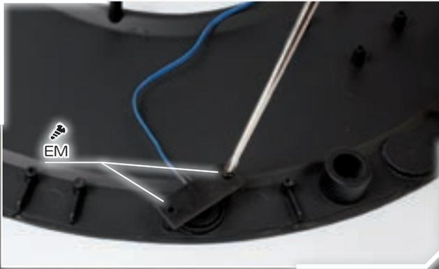
**3** - Осторожно переверните собранную в предыдущем шаге конструкцию и установите ее на свое место так, чтобы крепежные отверстия подставки и детали 1С совпали. После этого закрепите конструкцию двумя винтами EM.
