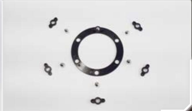
3 - Повторите указанные операции с остальными пятью шариками. Каждая деталь 13В крепится двумя винтами IP.
