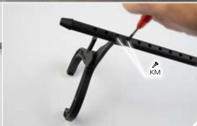
1 - Установите зажим на штангу подставки. Шипы кронштейна должны войти в отверстия детали 15А, после чего зажим надо закрепить двумя винтами КМ. На штанге имеется несколько отверстий, что позволяет регулировать высоту установки зажима.
