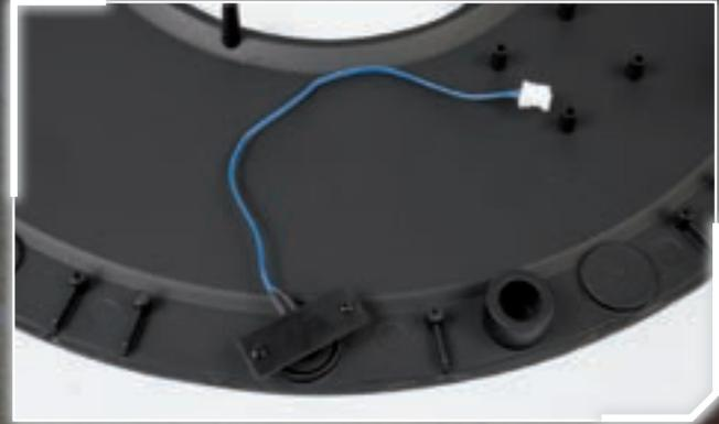
**4** - Закрутите винты так, чтобы выключатель был надежно зафиксирован своим креплением.
