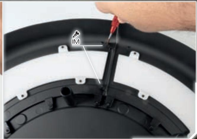
3 - Сначала зафиксируйте сегмент на детали 1А тремя винтами IM.
