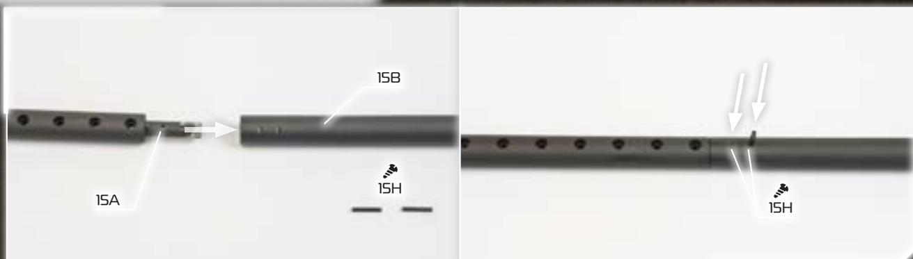
1 - Опорная штанга для подставки собирается из деталей 15А и 15В. Вставьте конец детали 15А в отверстие детали 15В. Поворачивайте одну из них в другой до тех пор, пока отверстия в этих деталях не совпадут, а затем зафиксируйте детали двумя штифтами (15Н). При необходимости аккуратно постучите по ним молотком, чтобы они вошли до конца.
