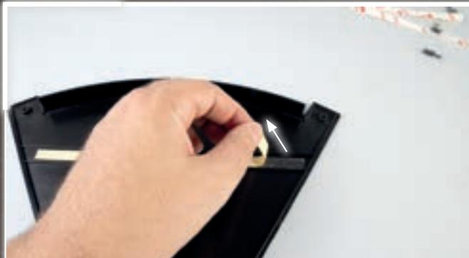
**3** - Аккуратно удалите защитный слой с внешней стороны наклеенной полоски двустороннего скотча, следя за тем, чтобы полоска не отклеилась от пластины (12A).
