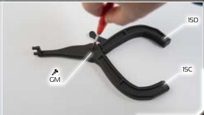
4 - Разместите сверху деталь 15C так, чтобы крепежные отверстия деталей совпали, после чего скрепите зажим винтом GM.
